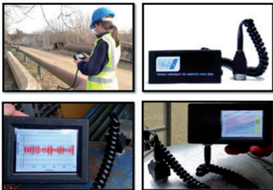
Figura 3: Sistema de análisis de vibraciones y matriz de riesgo por fatiga inducida por vibración
