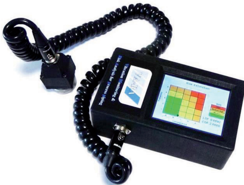
Figura 1: Sistema de seguimiento condicionado VA-RA
