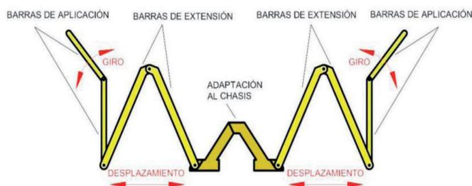
Fig. 2: Esquema de los elementos estructurales que componen el sistema mecánico. Un total de cuatro barras son utilizadas para la regulación en anchura y otras cuatro para adaptarse a la geometría y altura, a la vez que aplican el producto
