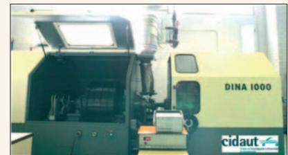
Figura 8: Detalle del dinamómetro empleado en las investigaciones de CIDAUT.
