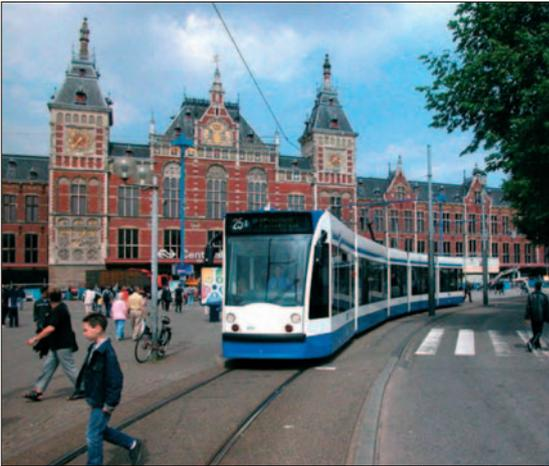
Fig. 8 Tranvía de piso bajo diseñado para prestar servicio en *Ámsterdam*.
