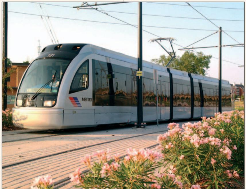
Fig. 10 El vehículo ligero de piso bajo *Avanto/S70* diseñado para el Transporte urbano en la ciudad de *Houston, Texas*.
