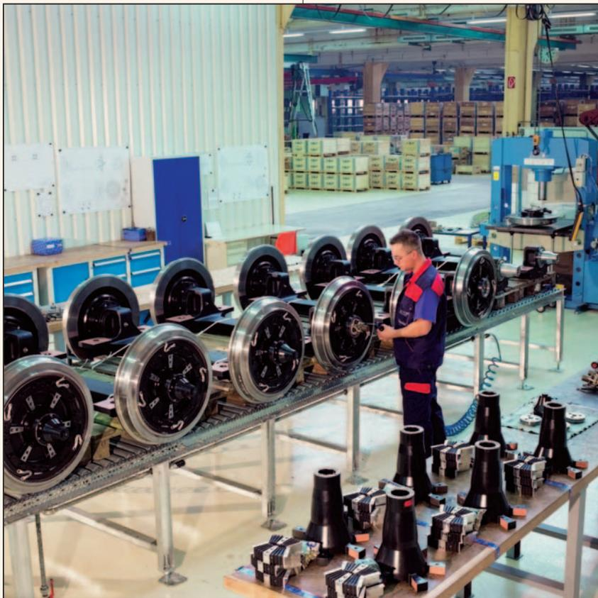
Fig. 7 Línea de montaje del eje-puente.
