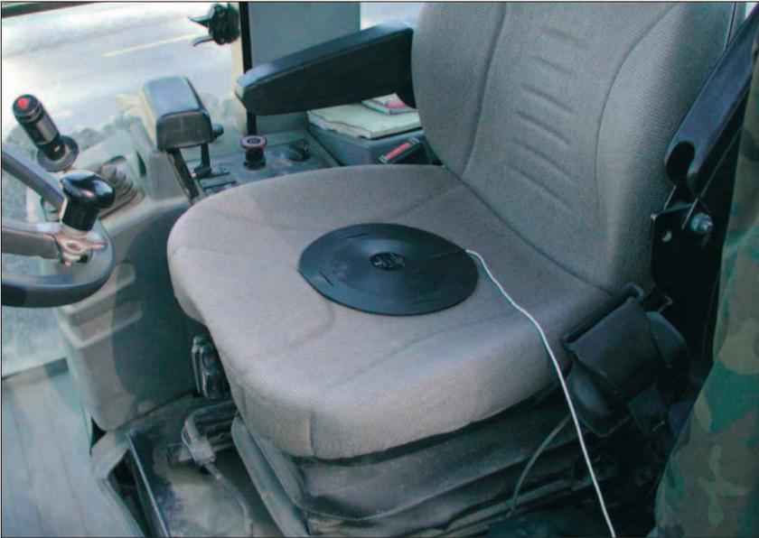
Figura 3. Acelerómetro triaxial de asiento.
