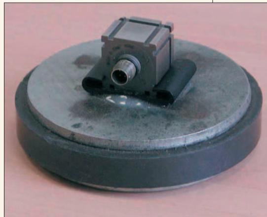
Figura 4. Acelerómetro triaxial miniatura.
