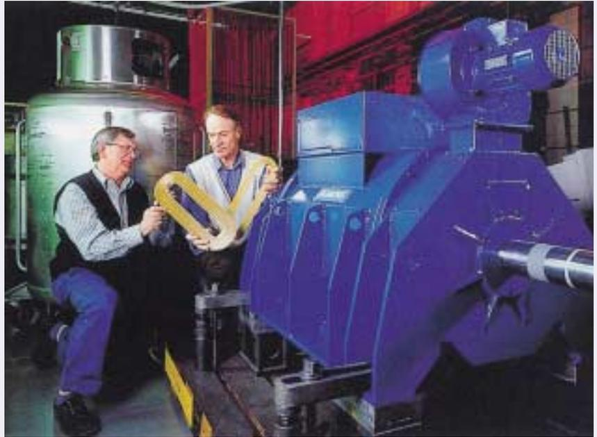
*Ensayo del nuevo motor dotado con superconductores de alta temperatura*
