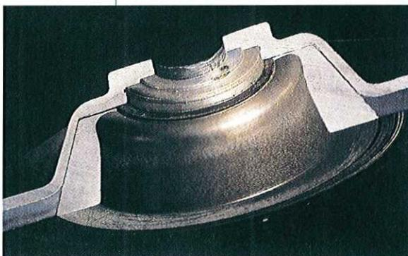
Fig. 1.- Sección transversal de una cámara de estanquidad con ranuras en espiral. Esta cámara se hizo del mismo material no resistente al desgaste y se expuso a las mismas condiciones. Tras 400 horas, no se pudo detectar ningún tipo de desgaste. El Spin-out no redujo el desgaste, sino que lo eliminó totalmente.
