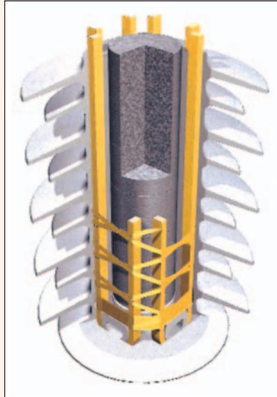
capacidad ignífuga y su resistencia a la luz y a la radiación UV, reducen la erosión salina y garantizan unas buenas propiedades eléctricas. La goma de silicona, además, soporta bien las corrientes de fuga gracias a sus buenas cualidades como soporte de cargas eléctricas y de aislamiento.
