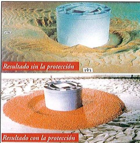
Ensayo del modelo hidráulico (Protección antierosión) 2.4.4a
