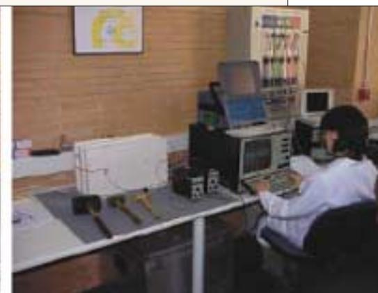
Medida de la velocidad de propagación longitudinal de las ondas en un material.
