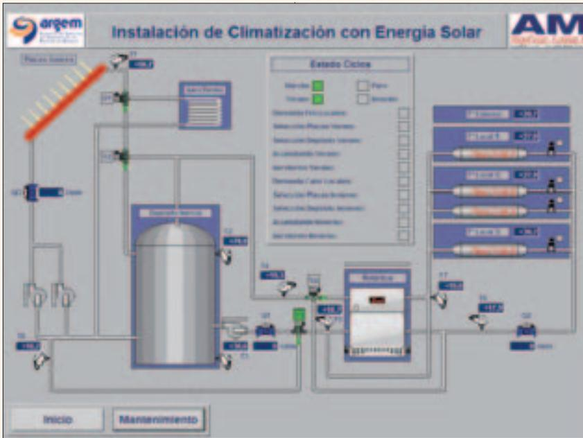
Figura 4.- Esquema de funcionamiento de la instalación.
