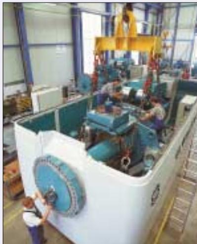
*Turbina eólica de 1,5 MW durante su fabricación en la fábrica de GE Wind Energy en Salzbergen*
