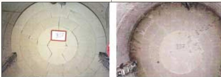
Figura 9. Comparación de una sección del ensayo recién instalada (izquierda) y tras cinco años de calentamiento e hidratación natural. Se observa que están cerrados todos los huecos que existían en el montaje.
