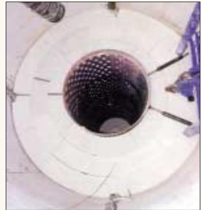
Figura 5. El proyecto *Febex* ha demostrado que es factible construir la barrera de arcilla con una densidad seca especificada que permita conseguir la permeabilidad y presión de hinchamiento requeridas
