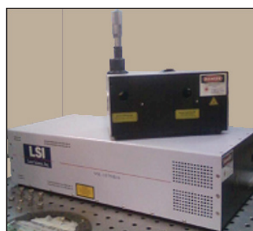
Fig.2: Láser de bombeo de nitrógeno con la plataforma para cubetas de colorante (encima). Ésta dispone de un tornillo micrométrico con el que manualmente se gradúa la salida con resolución de 1 nanómetro.
