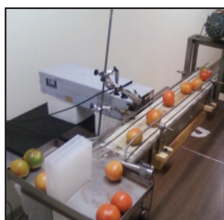
Fig.8: Prototipo en funcionamiento. Las configuraciones de medida mantienen los ángulos y la disposición usados en el laboratorio. Sobre el área de medición se coloca una caja negra (no mostrada) para aislarla de la iluminación exterior. El computador empleado para el montaje en el prototipo es el mismo que el usado en el laboratorio para la construcción del modelo y la velocidad de la cinta donde se colocan los detectores es de unas dos unidades por segundo.
