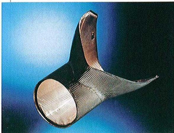
Estas protecciones tienen la apariencia de *sandwich* multicapas que se componen, en cuanto a la parte externa, de hojas metálicas. En lo que se refiere a la "guarnición", los principales materiales son capas de fibra de vidrio, cerámica, cuarzo o aislantes microporosos.
