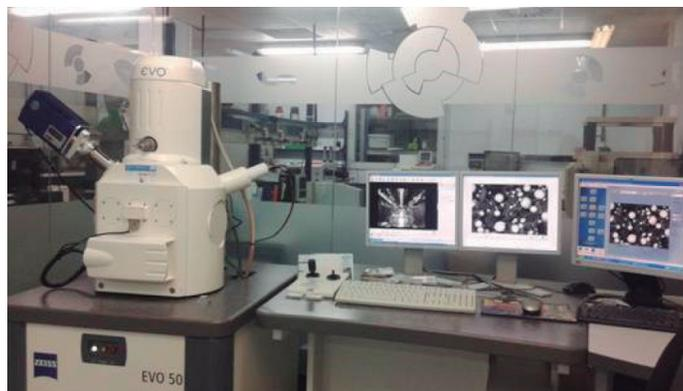
Fig. 2: Microscopio electrónico de barrido SEM
