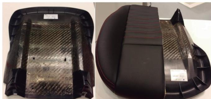
Fig. 1: Pieza de automóvil de composite termoplástico correspondiente a un asiento de polipropileno reforzado con fibra de vidrio
