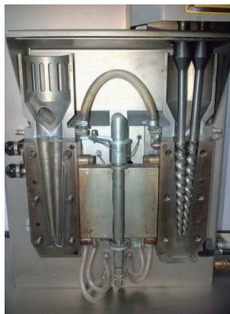
Fig. 3: Equipo de mezclado Twin Screw compounder DSM Xplore
