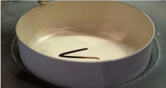
Figura 1: Cazoleta obtenida tras los procesos de corte y embutición
