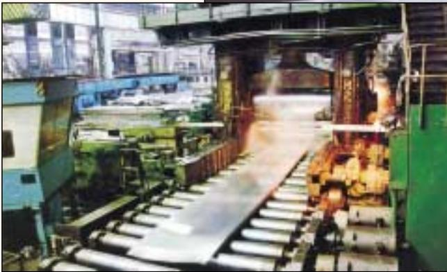
*Las planchas de aluminio se mueven en vaivén hasta alcanzar seis centímetros de espesor*
