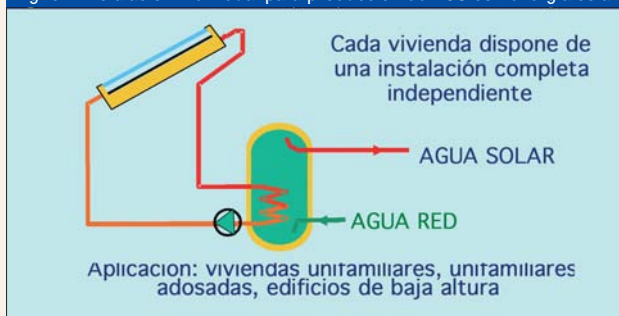
Fig. 01: Instalación individual para producción de ACS con energía solar
