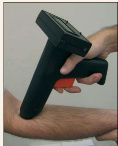
Figura 7.- Aplicación del dolorímetro SMD en un punto gatillo.
