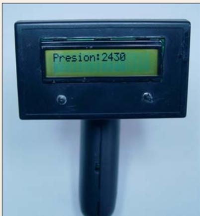
Figura 8.- Visualización de la presión instantánea que se está aplicando.
