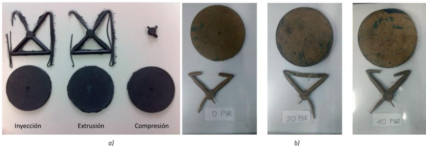
Figura 5: a) Llenado del molde de fluidez de las mezclas diseñadas de acuerdo con el grado de procesado de la mezcla. b) Llenado del molde de fluidez de las mezclas diseñadas con caucho natural y residuos de cuero
