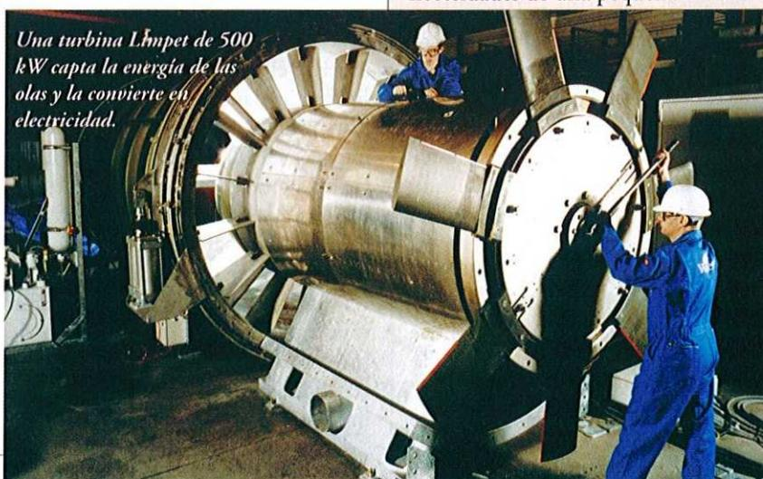
Una turbina **Limpet** de 500 kW capta la energía de las olas y la convierte en electricidad.
