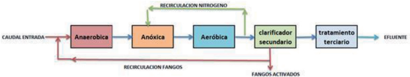
Fig. 1: Diagrama de flujo del Proceso de Aireación prolongada con eliminación de Nitrógeno
