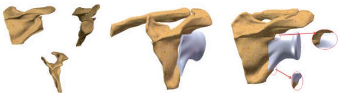
Con las operaciones ya definidas mediante un número limitado de valores, se procede a transformar el modelo no paramétrico importado a Solidworks ® en un modelo parametrizado (Fig. 14).
