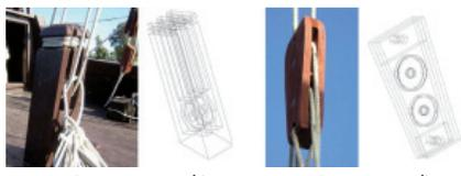
Fig. 9: a) reconstrucción de un polipasto en horizontal b) dibujo que muestra el interior de las ruedas de un polipasto en horizontal c) reconstrucción de polipasto en vertical d) dibujo que muestra el interior de las ruedas de un polipasto en vertical.
