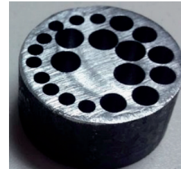
Fig. 1: Probeta taladrada de acero aleado C45E para medir la maquinabilidad usando diferentes brocas.
