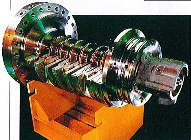
Ambos tipos pueden construirse sin y con uno o dos pares de tubuladuras para la refrigeración intermedia externa.
