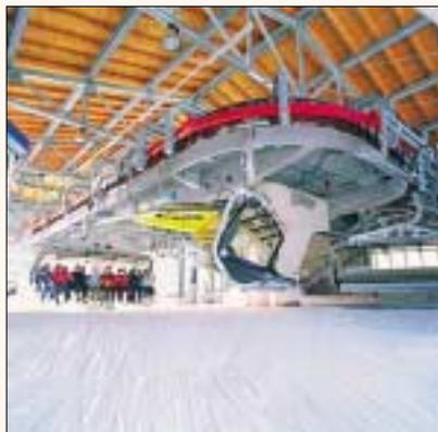
Fig. 3.- Telesilla desembragable. Estación de reenvío cubierta. Obsérvese en primer plano la separación del cable-polea y la cadena cinemática de deceleración de la silla. (Cortesía de **Doppelmayr**)
