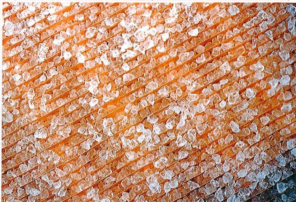
*El vapor de agua presente en el medio ambiente es fijado por adsorción por el gel de sílice del deshumidificador rotativo*
