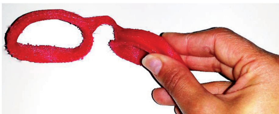
Fig. 4: Prototipo flexible de la montura de natación realizado en poliuretano termoplástico
