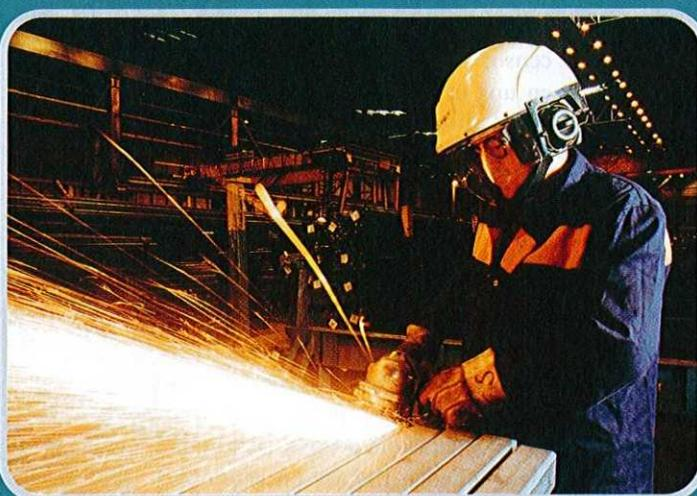
*Integra*, protegen la cabeza, la cara, los ojos, los oídos y el tracto respiratorio siendo ideales para diversas industrias. En la foto vemos cómo se utilizan en una instalación de laminación por parte de los inspectores de calidad que utilizan pulidoras abrasivas para eliminar cualquier defecto
