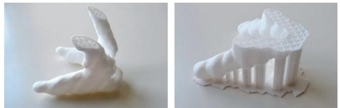
Fig. 8: Pieza optimizada impresa. A la izquierda sin soportes y completada al 85%. A la derecha con los soportes y completada al 50%
