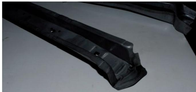
Fig. 20: Imagen del travesaño después de la operación de corte (operación 30)
