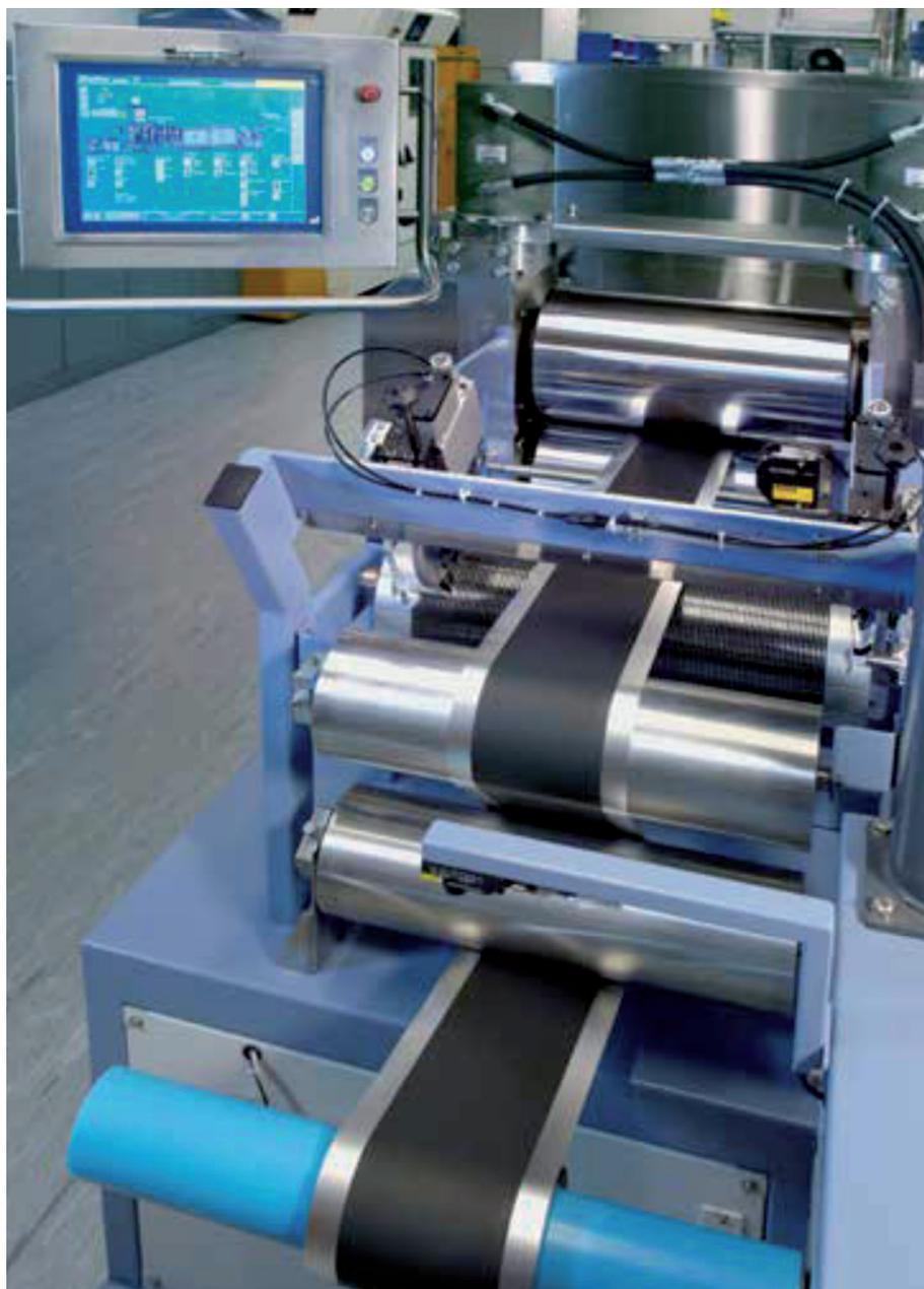
Fabricación de electrodos según la técnica de capas de Fraunhofer-ISIT
