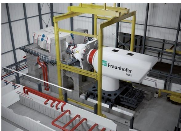
Banco de ensayo de “nacelles” (góndolas) de aerogenerador
