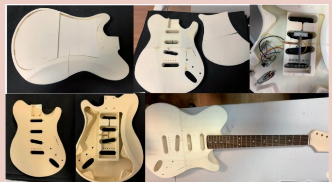
Figura D: Postprocesados: Retirada de soportes, unión de piezas, montaje de electrónica, imprimación y unión del mástil
