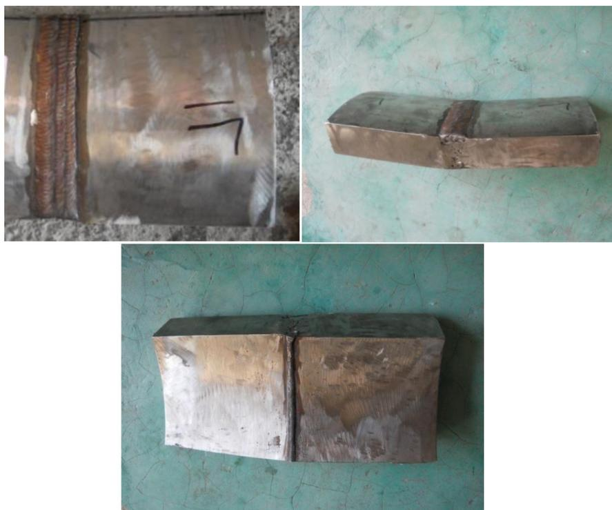
Fig. 2: Probeta PJ1 para el análisis de esfuerzos residuales
