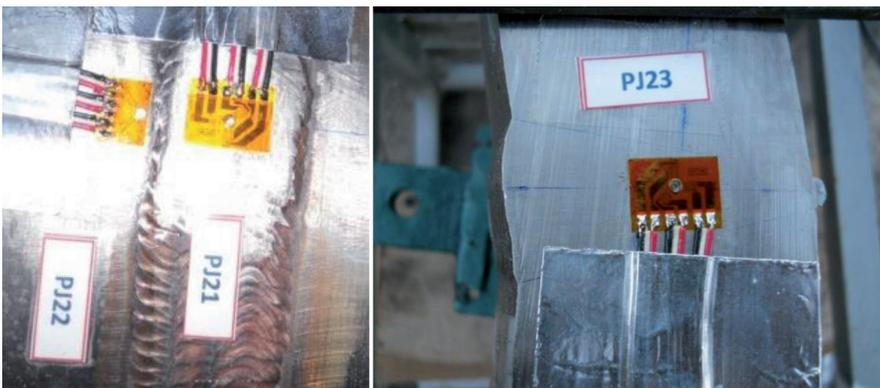
Fig. 11: Puntos barrenados y analizados experimentalmente en la probeta PJ2
