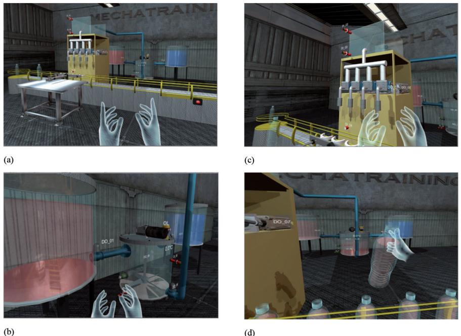
Fig. 1: Planta embotelladora virtual. (a) Vista general. (b) Sistema de mezclado y calentamiento. (c) Sistema de llenado. (d) Operador manipulando una botella llena
