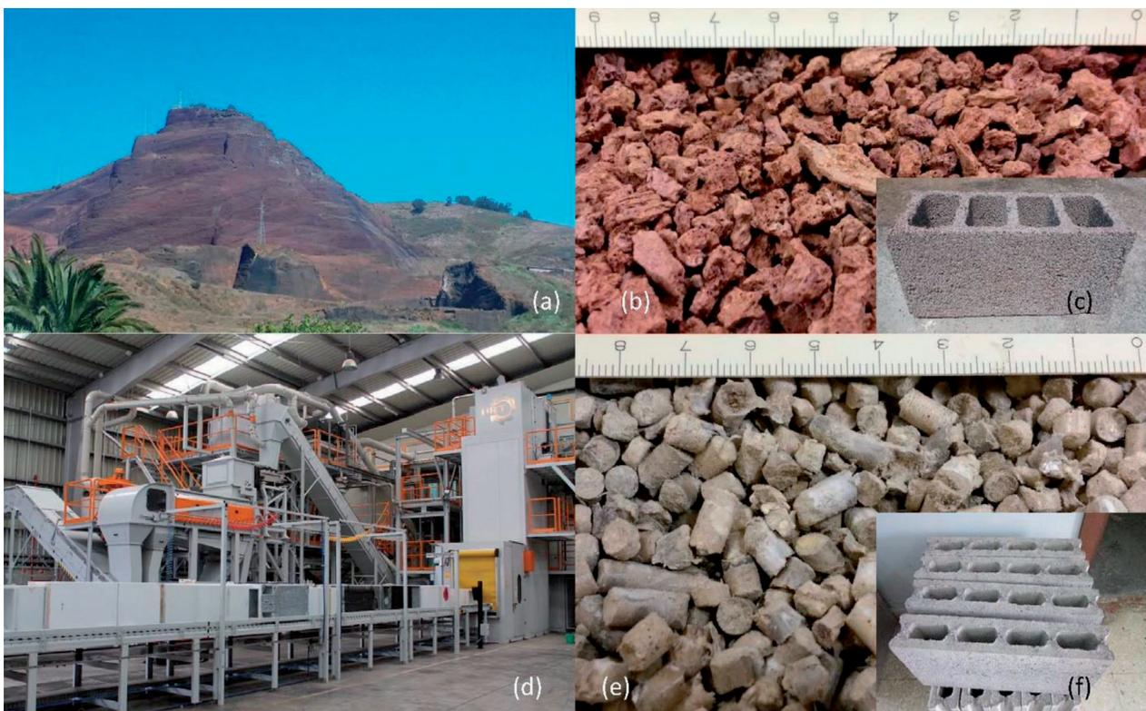
Fig. 1: Cantera de lapilli (a). Áridos de lapilli basáltico (b). Ejemplo de bloque de hormigón canario de 50 cm x 25 cm x 20 cm fabricado con lapilli (c). Imagen parcial de la planta de reciclaje de Ewaste (d). Residuos de pellets de poliuretano (e). Ejemplo de prototipo de bloque de hormigón de 50 cm x 25 cm x 9 cm fabricado con PUR-pellets (f)
