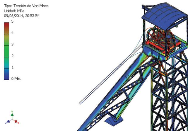
Fig. 8: Tensión de Von Mises sobre el conjunto y sobre las partes móviles
