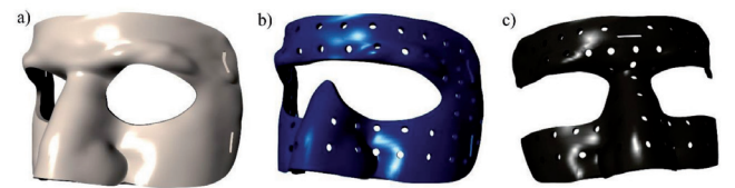
Fig. 2: Máscara con dos agujeros para los ojos y sin agujeros de ventilación (1), máscara con un único agujero para los ojos y agujeros de ventilación circulares y máscara con dos agujeros para los ojos, abierta en los extremos y con patrón circular de agujeros(c)
