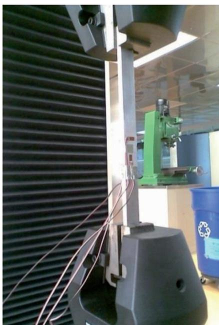
Fig. 9: Prueba de tensión simple, MCL metálico A-L-A, acercamiento
