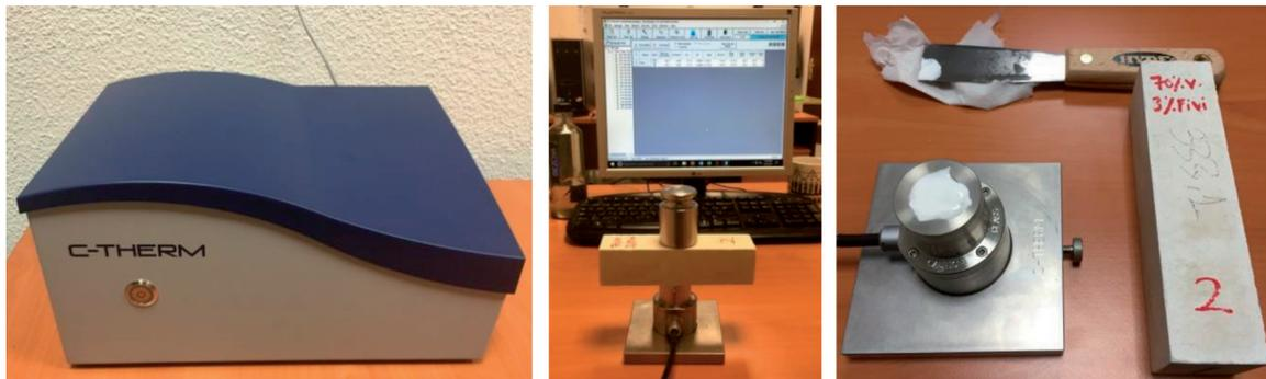
Fig. 2: Equipamiento utilizado para la caracterización térmica del material
