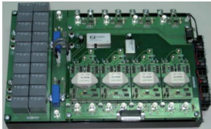
Fig. 6: Fotografía del convertidor electrónico tetrafásico construido
