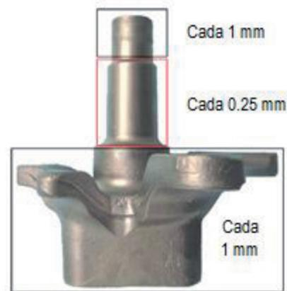
Fig. 6: Inspección tomográfica para el componente del material LTT C45
