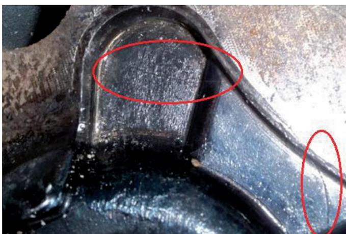
Fig. 8: Grietas del molde inferior
