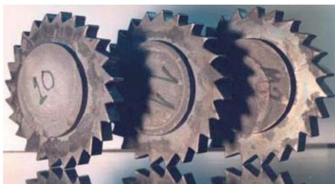
Fig. 2: Ruedas dentadas de acero M2 fabricadas por tixoconformado [2]
