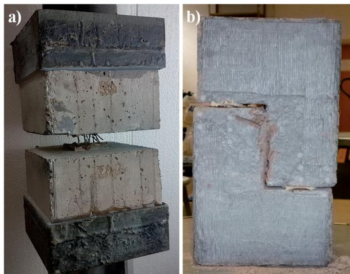
Fig. 2(a): Probeta ensayada en ensayo uniaxial y 2(b): Probeta ensayada en ensayo "push-off"
