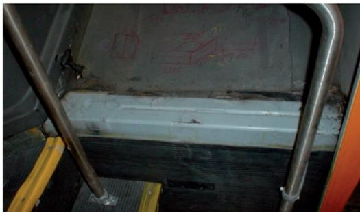
Figura 8: Modificación en el piso, zona de escalones de la puerta de ascenso
