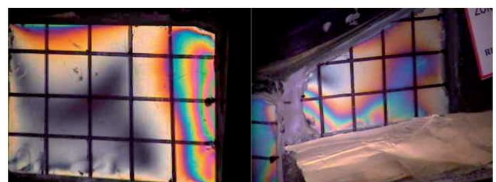
Figura 4: Patrón de franjas isocromáticas en la prueba de torsión a PV, levantamiento rueda delantera izquierda y levantamiento de rueda delantera derecha
