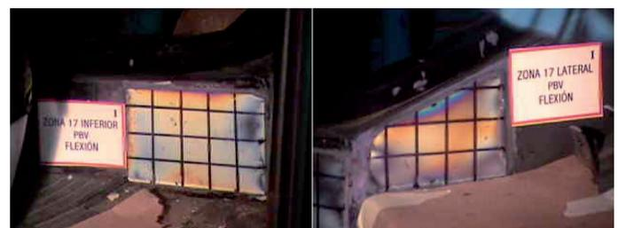
Figura 3: Patrón de franjas durante la prueba a flexión a PV
