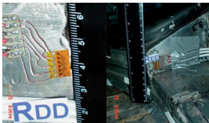
Figura 6: Rosetas instrumentadas en los puntos que durante las pruebas presentaron mayor nivel de esfuerzos, Rosetas RDD y REE
