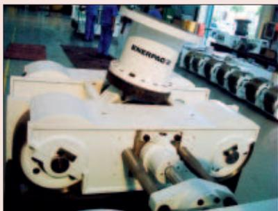
*Los cilindros hidráulicos compensan los movimientos oscilantes horizontales de las carretillas y evitan su descarrilamiento.*
