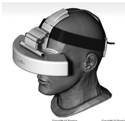
Fig. 1: Ejemplo de un casco HMD (creative commons-SENSICS)
