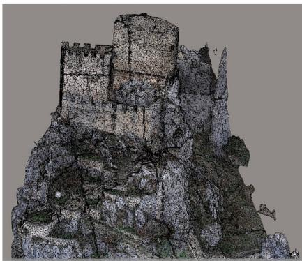
Fig. 3. Nivel de detalle de la malla procesada fotogramétricamente con Bentley iTwin Capture Master.
